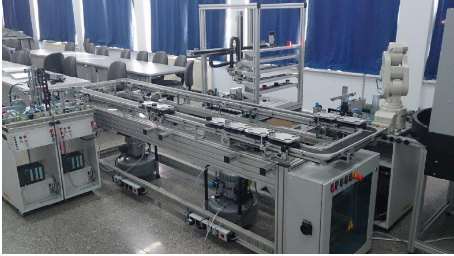
Şekil 7.2 Altı istasyonlu montaj hattı otomasyonu sistemi
